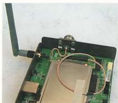
D-Link DWL-900AP+ geopend met N-chassisdeel in plaats van interne antenne.
